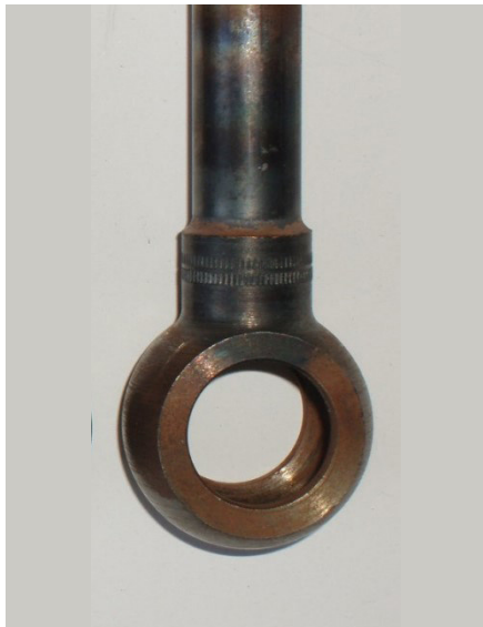
▲ Bild 7. Ringstück in Rohr (12 mm × 1 mm), mit Kupferlot unter Schutzgas induktiv mit 5 kW in 8 s gelötet, ohne Abkühlung unter Schutzgas (Bilder: [1] (1, 7), Emag eldec (2, 5, 6), MiniTec Berlin (3, 4))
