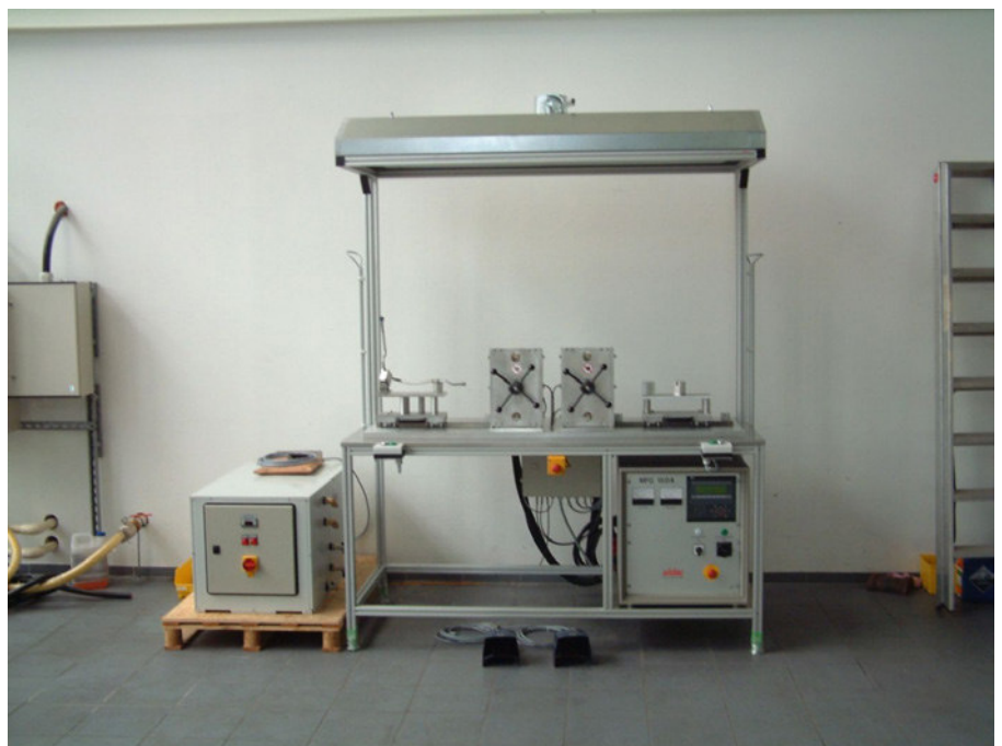
▲ Bild 5. Schutzgaslötanlage zum wechselseitigen Löten von Rohren mit Ringstücken mithilfe eines 15-kW-Generators mit zwei Leistungsausgängen
